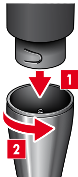
Rys. 3: Mocowanie przystawki do blendera
