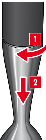
Rys. 7: Zdejmowanie przystawki miksującej
