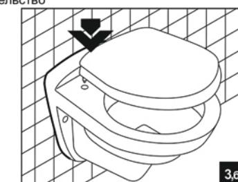
Закрепить унитаз к инсталляции согласно инструкции, прилагаемой к инсталляции;
