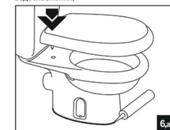
Надеть прокладку. Установить бачок на унитаз и прикрепить его с помощью болтов;
