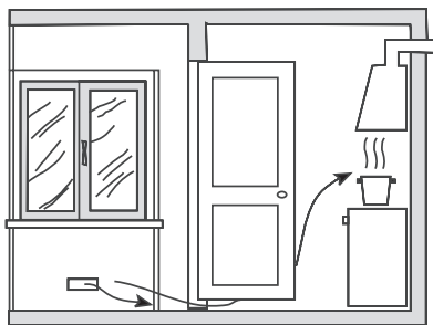
Мал. 3. Забезпечення необхідного зазору між дверима приміщення та порогом для вільного проходження приливногo повітря
